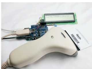
Εικόνα 3.9. Συσκευή γραμμωκώδικα με χρήση πλακέτας Arduino.
